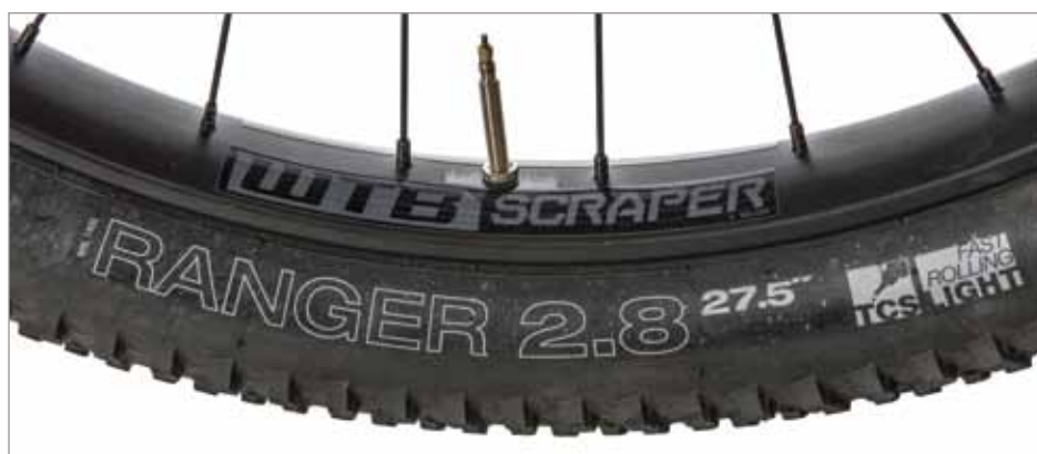
Les jantes et pneus WTB Scaper font partie de l'équipement trop basique du vélo au regard de son prix. Si les pneus ne sont pas adaptés à nos terrains, les jantes, elles, se sont avérées de très bonne qualité. Un conseil: démontez le pneu pour remplacer le fond de jante minimaliste.
