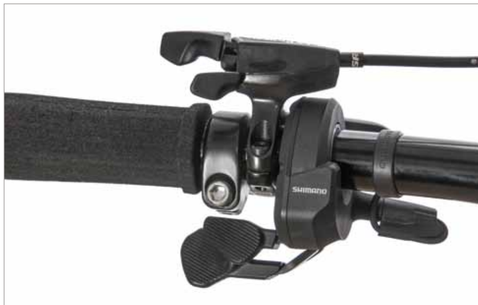
Ces deux leviers Di2 activent l'assistance. Le petit pour l'augmenter et le grand pour la diminuer.
