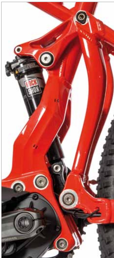
Sur la suspension FSS, l'amortisseur n'a aucun point de fixation sur le cadre car il flotte entre deux biellettes qui font la connexion entre triangle avant et arrière. Wilier est parvenu à maintenir cette conception grâce à la compacité du moteur Shimano.
